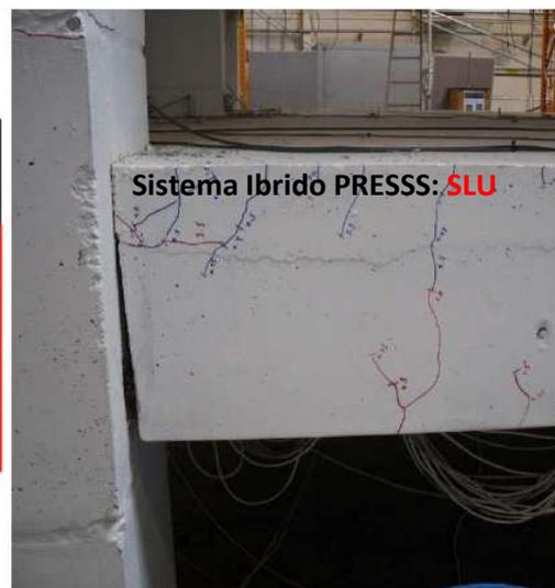
Figura 11: Danneggiamento trave con sistema ibrido PRESSS-Lam
