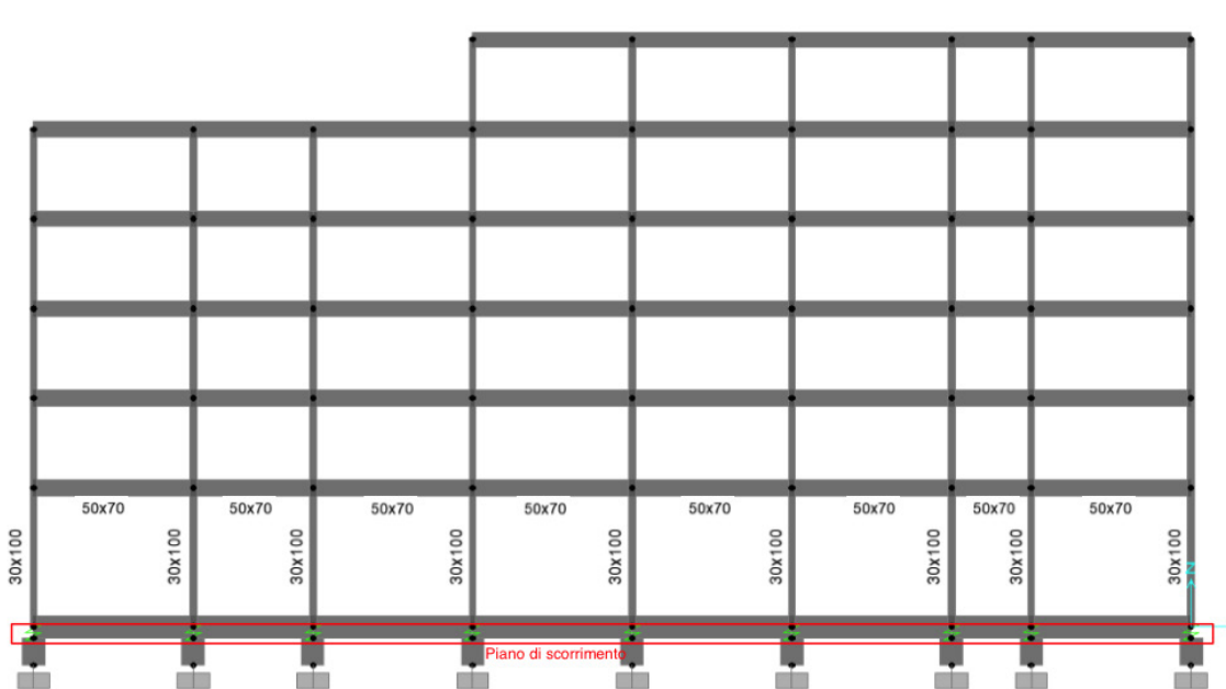
Telaio frontale con indicazione dell'interfaccia di isolamento
